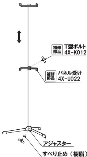
補修部品 T型ボルト 4X-K012
