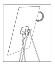
面板部分の角度を変えることができます。 脚を押さえながら面板の角度を お好きな角度に調節してください。
