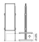
段差対応:0~270mm 傾斜対応:0~15度
